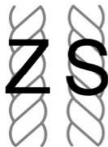
Figura 2.21 - Torções Z e S, respectivamente.
