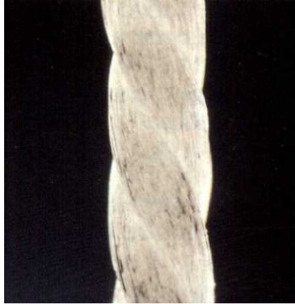
Figura 2.9 - Fio Retorcido em dois cabos. Fonte: LADCHUMANANANDASIVAM, 2006
