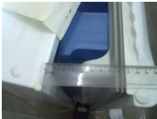
Figura 3.7 - Abertura de 8 centímetros que permite que o refrigerador troque calor com o ambiente.
