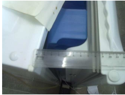
Figura 3.10 - Abertura da porta do frigobar em 8 centímetros.
